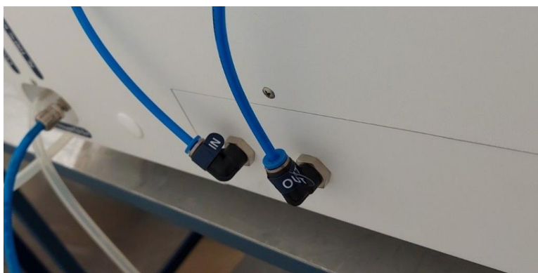
23.1 pav. Vamzdelio prijungimas prie drėkinimo butelio ir prie „MIRI® Humidity“ daugiakamerio IVF inkubatoriaus
