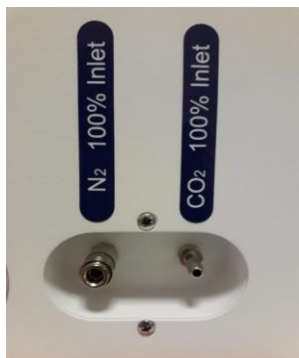
11.1 pav. Dujų tiekimo angos MIRI® ir „MIRI® Humidity“ daugiakamerių IVF inkubatorių užpakalinėje dalyje
